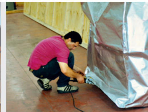
Il materiale sigillato ermeticamente sottovuoto è protetto da corrosione ed agenti atmosferici.
